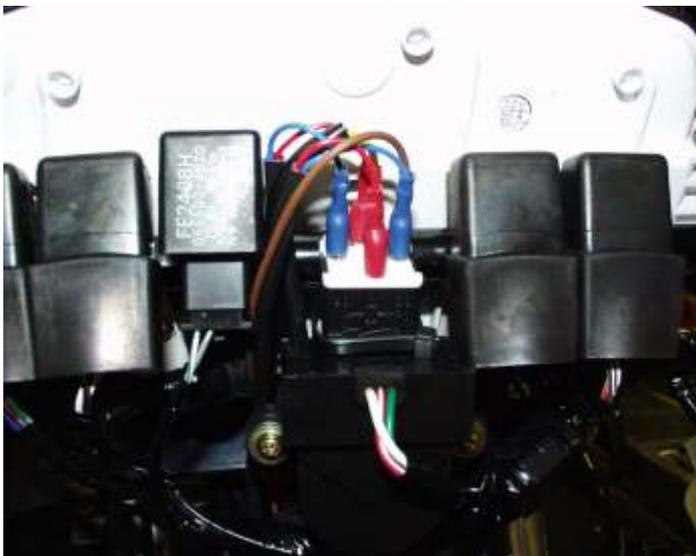
Demontieren Sie zunächst Verkleidungsseitenteile und Verkleidungsoberenteil. Befestigen Sie das Relais mit einem Kabelbinder am Instrumentenhalter. (Bild1) Ziehen Sie das gelbe Kabel nach unten zum Anschlußstecker des Standlichts. Kürzen Sie das Kabel entsprechend und schließen Sie es mit dem Quetschverbinder am braunen Kabel an.
