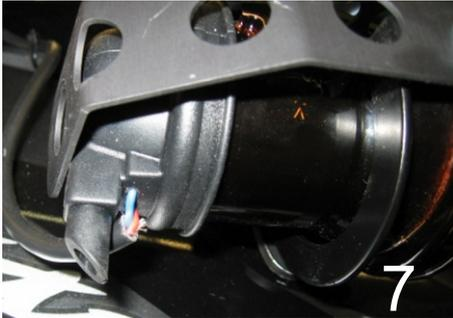
Kürzen Sie das blaue und rote Kabel entsprechend und ziehen sie es durch die beiden dafür vorgesehenen Durchgänge an der Unterseite der hinteren Nebelscheinwerferabdeckung.
