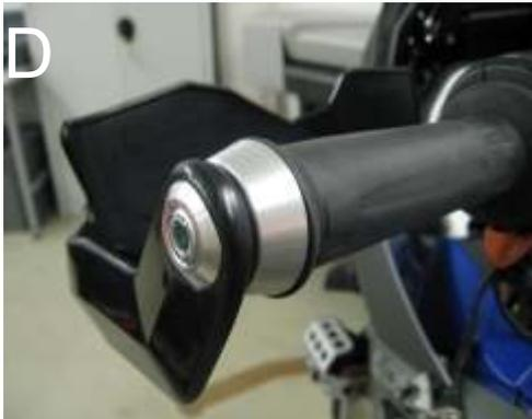
4. Befestigen Sie jetzt noch den Protektor an der langen Distanz. Benutzen Sie dafür die Schraube M6x20 mit der großen U-Scheibe, E.
