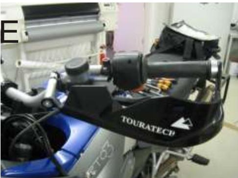
Bringen Sie Die Protektoren in die Richtige Position, sodass Kupplungs- und Bremsgriff nirgends anstoßen. Ziehen Sie anschließend alle Schrauben fest.
