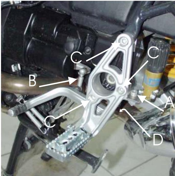
A: Schrauben Sie bitte die hydraulische Federbeinverstellung ab.
