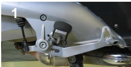
**Überprüfen Sie nach einem Sturz unbedingt die Freigängigkeit des Bremshebels!**
