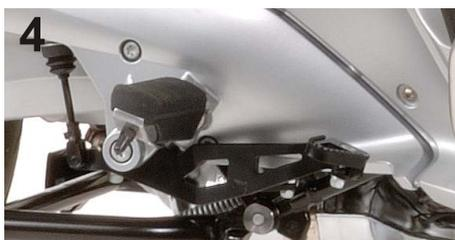
4.) Ziehen Sie alle Schrauben endfest. Überprüfen Sie vor Ihrem nächsten Fahrtantritt alle von Ihnen an- oder umgebauten Teile auf festen Sitz und korrekte Funktion. Nach einem Sturz oder wenn der Hebel verbogen wurde, prüfen Sie unbedingt die Freigängigkeit des Hebels!
