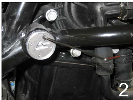
3.) Setzen Sie nun das Inlay von vorn in den Rahmenstopfen und fixieren Sie es mit den im Lieferumfang enthaltenen Schrauben M2x6. Schrauben Sie die Schrauben noch nicht bis auf Anschlag an.
