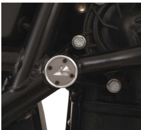
5.) Nun ziehen Sie die Schrauben mit einem Drehmoment von max. 1,5 Nm an. Dadurch wird der O-Ring noch ein wenig verspannt und sichert den Rahmenstopfen zusätzlich. (Bild 2)
