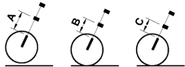
S2.1 - Durchhang Messungen Vorderseite
