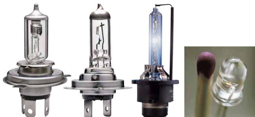
Von links nach rechts: Bilux-Lampe mit zwei getrennten Glühwendeln; Halogenlampe, ihr Glaskolben ist mit Brom- oder Joddampf gefüllt; Xenonlampe oder Gasentladungslampe, sie erzeugt Licht durch Lichtbogen aus ionisiertem Gas; Hochleistungs-LED.
