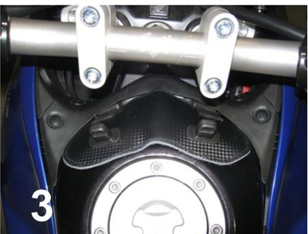
Entfernen Sie die Sitzbank. Befestigen Sie die Kletthalteplatte mit den zwei Klettstreifen gemäß der Abbildung. Befestigen Sie die Sitzbank wieder und fixieren Sie die Halteplatte mit dem beigefügten Klettstreifen. Abbildung 4
