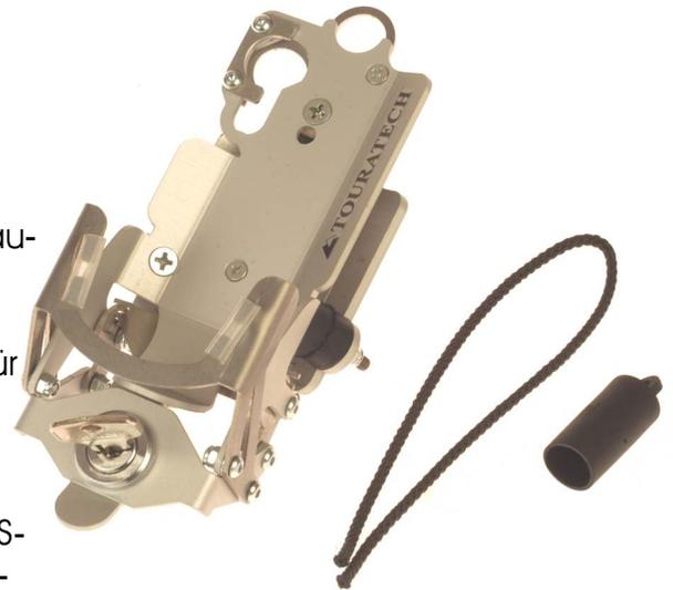
Zum Einsetzen des Geräts müssen Sie den Betätigungshebel hinunter drücken und den schwarzen Kunststoffknopf aus dem Lieferumfang des Gerätes installiert haben.
