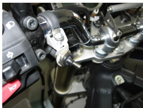
7. Den Schalter mittels der Klemmschelle links am Lenker fixieren (Bild5)
