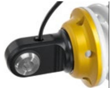
Superleicht: Buchsen aus Aluminiumlegierung
